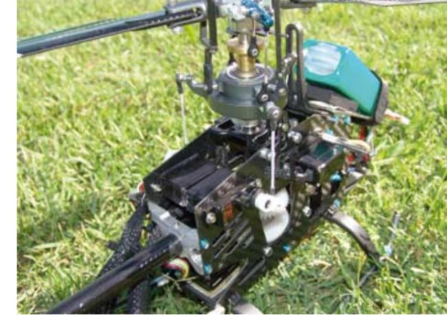
Blick auf die beiden Rollservos der 120-Grad-Anlenkung und die Heckrohr-Halterung
