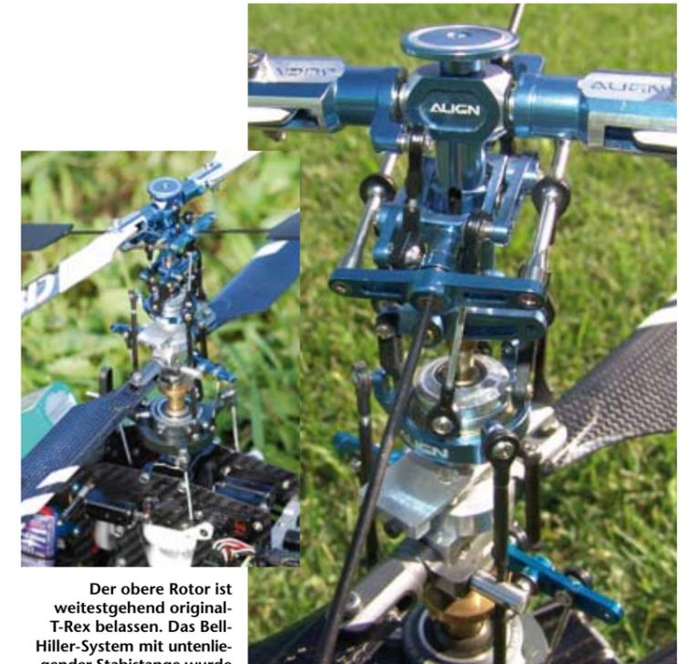
Der obere Rotor ist weitestgehend original-T-Rex belassen. Das Bell-Hiller-System mit untenliegender Stabstange wurde hier ebenfalls beibehalten. Die entsprechende Taumelscheibe ist über Gestänge mit der unteren gekoppelt
