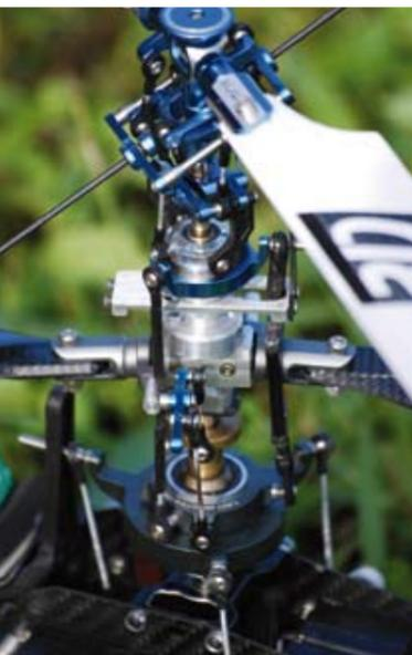
Raffiniert gelöst: Der Mithnehmer der oberen Taumelscheibe ist am Ende des Zentralstücks verschraubt
