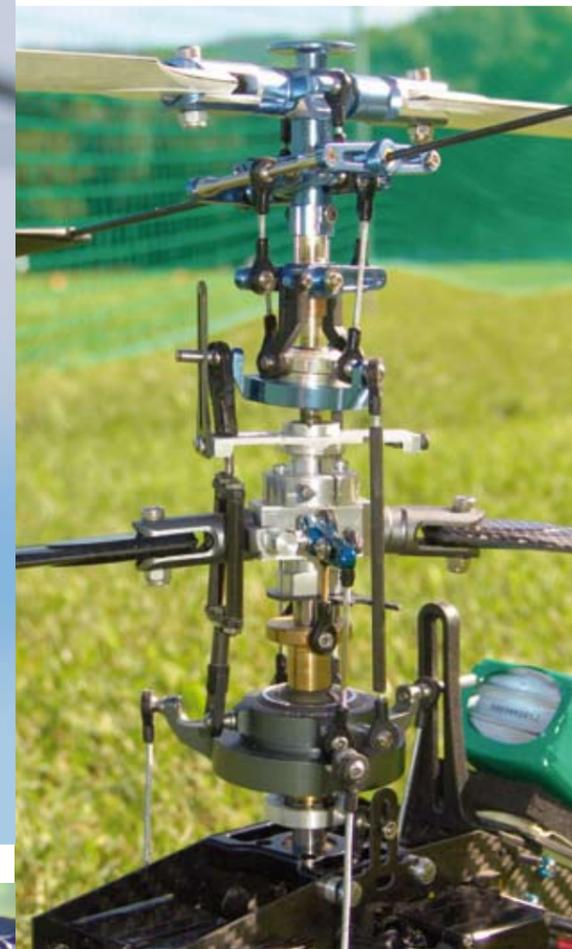
Die Seitenansicht der beiden gegenläufigen Rotoren verdeutlicht deren Verbindungen. Beide Taumelscheiben sind über Gestänge gekoppelt und bewegen sich somit parallel. Über der unteren Taumelscheibe ist auf der Rotorwelle die Messing-Schiebehülse zu erkennen, mit der die Gier-Funktion gesteuert wird (siehe Text)
